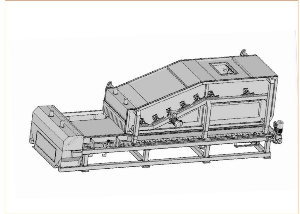
Il sistema BDB integra in una sola macchina le funzioni di un bunker e di una bilancia continua. È possibile variare il dosaggio modificando la velocità del nastro.
