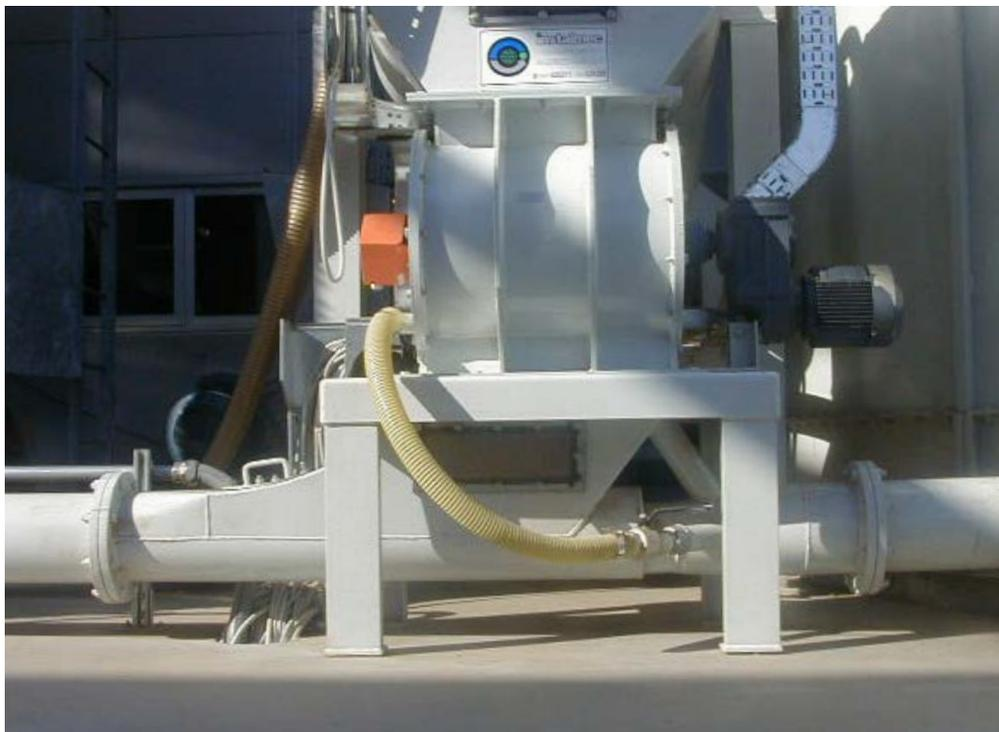
При более активном использовании переработанной древесины, в составе пыли появляется все большее количество кремнезема, это вызывает значительные проблемы износа машин, предназначенных для дозирования, транспортировки и использования пыли. Бункер-дозатор Инсталтек оснащен рядом выводных шнеков, в зависимости от его размеров.
