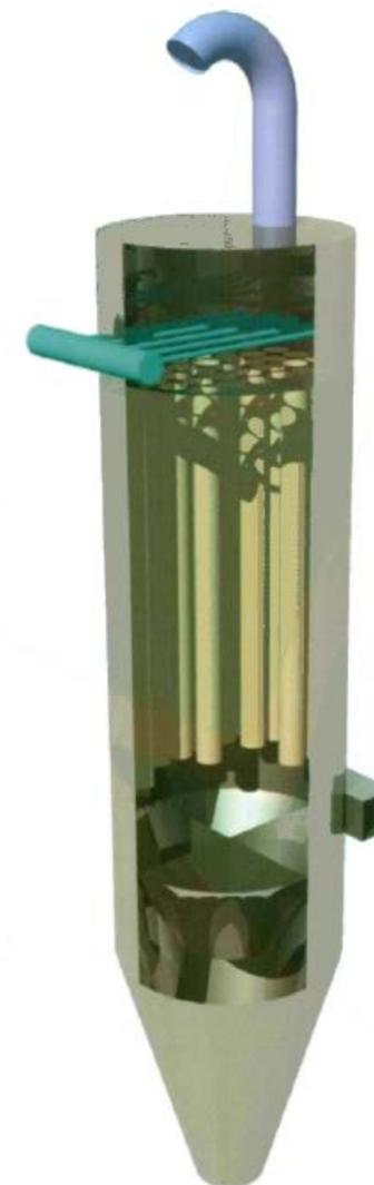
Принцип циклона позволяет осуществлять сортировку крупных частиц, благодаря большей скорости потока воздуха, что в итоге сокращает концентрацию пыли в фильтрующих рукавах.
