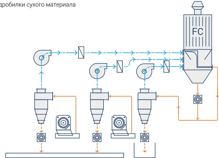
> Вытяжка сепараторов, очистителей и пр. (влажный и сухой материал)
