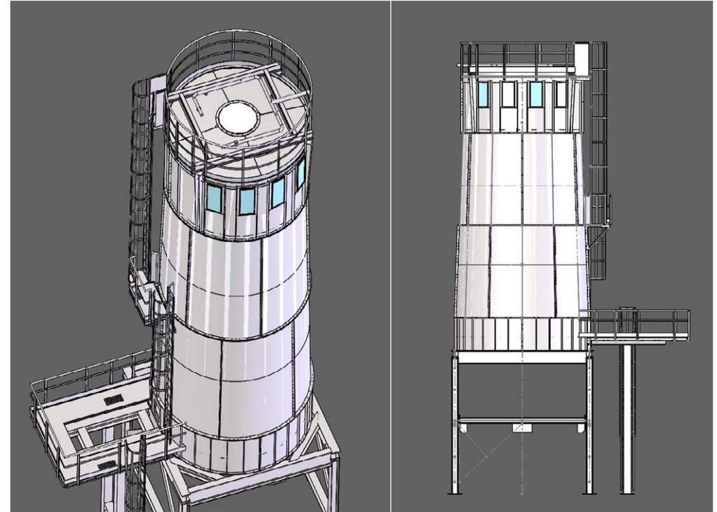
Il silo è una struttura in acciaio/metallo utilizzata per immagazzinare particelle di legno, polvere o granuli. Instalmec realizza sili imbullonati o saldati completi di sistema di estrazione, in accordo alle richieste del cliente.
