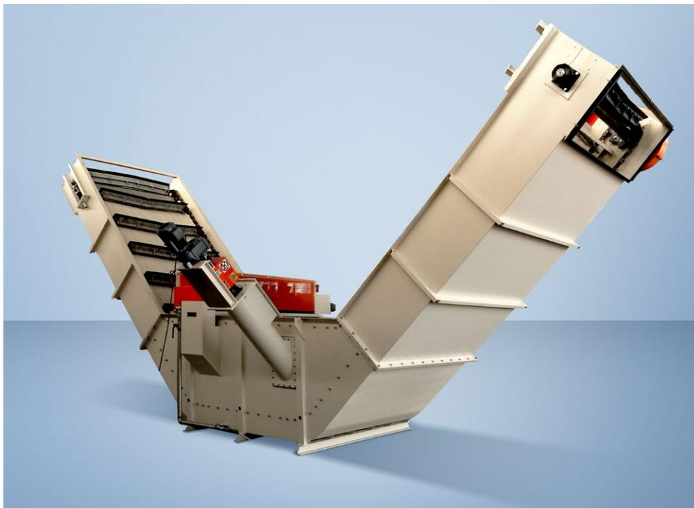
Il materiale da pulire viene introdotto nel separatore ad acqua tramite una coclea dosatrice. Le particelle leggere galleggiano, mentre gli inquinanti pesanti quali sassi, metalli, vetro, ecc. cadono sul fondo e sono rimossi da un nastro trasportatore. Sul lato opposto del separatore il nastro trasporta il materiale galleggiante pulito che è pronto per essere inviato alla produzione. Uno strumento apposito aiuta ad affondare il materiale ottimizzando il processo di pulizia.
