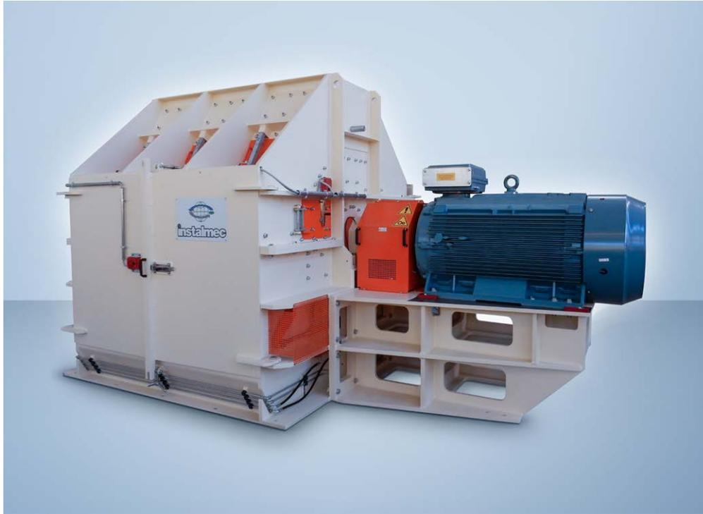
Il nostro mulino con motore diretto controllato con inverter è progettato per legno riciclato. La gestione di controllo collega l'assorbimento con il carico e quindi ottimizza i consumi. La macchina ha griglie speciali, molto resistenti, facilmente sostituibili, con questo tipo di mulino è possibile variare la granulometria in accordo alla richiesta dello spessore del pannello da produrre. Il rotore è in grado di ruotare in due direzioni, utilizzando entrambi i lati dei martelli.
