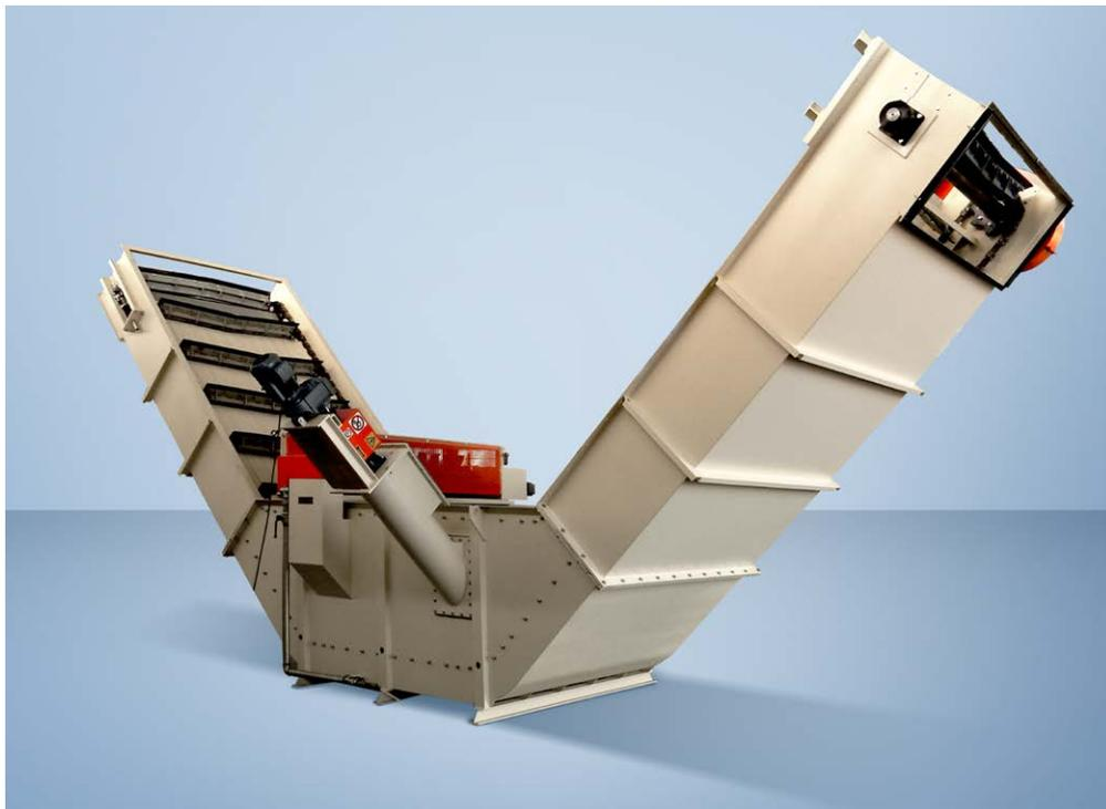
Материал для очистки поступает в водный сепаратор через дозирующий шнек. Легкие частицы остаются на плаву, в то время, как тяжелые загрязняющие, такие как камни, металл, стекло и пр. оседают на дно и удаляются посредством цепного транспортера. С противоположной стороны сепаратора по цепи перемещается чистый плавучий материал, готовый к отправке в производство. Специальное устройство способствует погружению материала, оптимизируя процесс очистки.
