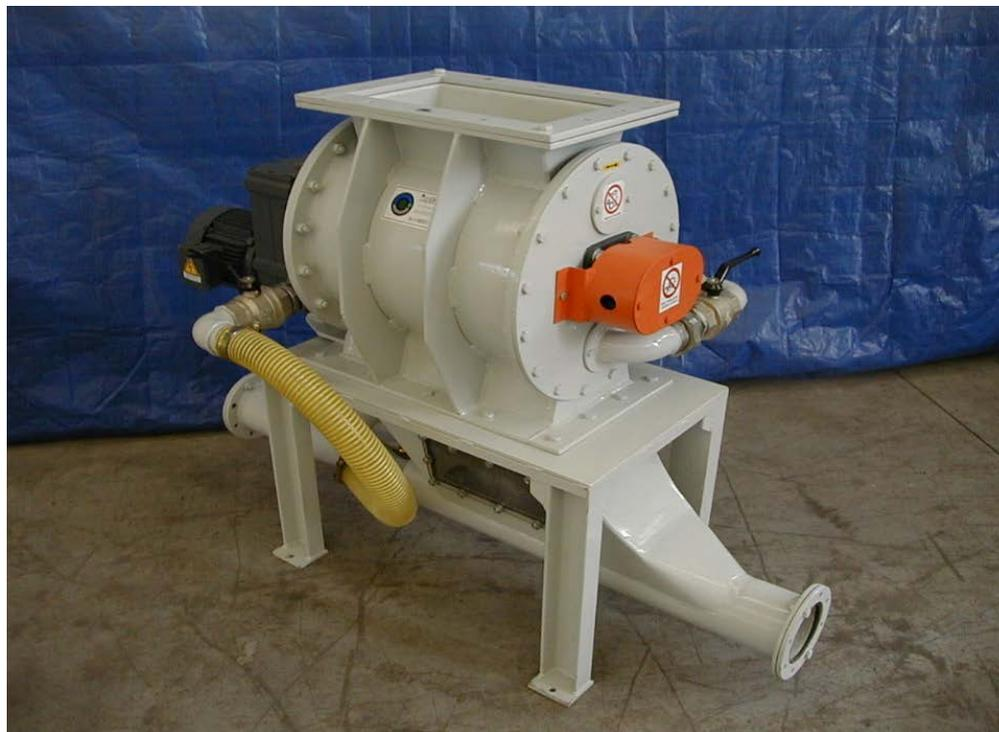
Adatta ad applicazioni a media pressione. Costruita in acciaio al carbonio, il sistema di tenuta è costituito da bavette in gomma ad alta resistenza all'abrasione e da un dispositivo anti ribaltamento. Dispositivo meccanico "rasatore" assicura il riempimento costante dei lobi eliminando problemi di sovraccarico. Su richiesta cassa in acciaio inox oppure cromata. Adatta per impianti in depressione.
